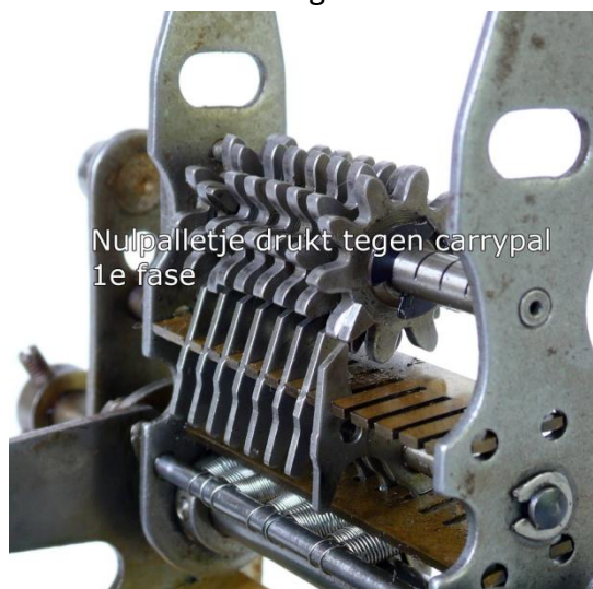
Als carrypal is ingedrukt dan 2e fase: kleine tandheugel wordt geactiveerd, maar nog tegen gehouden door balkje
