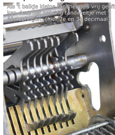
Als carrypal is ingedrukt dan 2e fase: kleine tandheugel wordt geactiveerd, maar nog tegen gehouden door balkje
