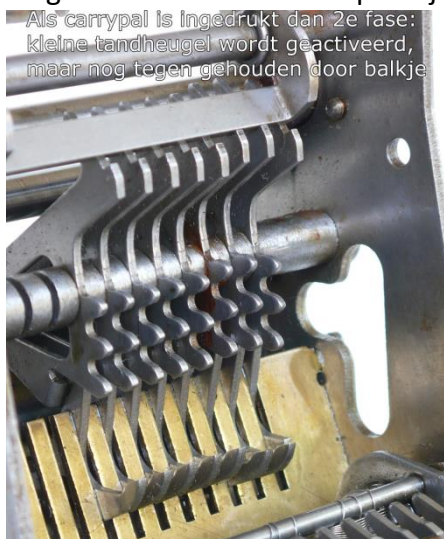
Als 't balkje kleine tandheugels vrij geeft kan deze het naburig tandwiel met één ophogen. (hier 2e en 3e decimaal)
